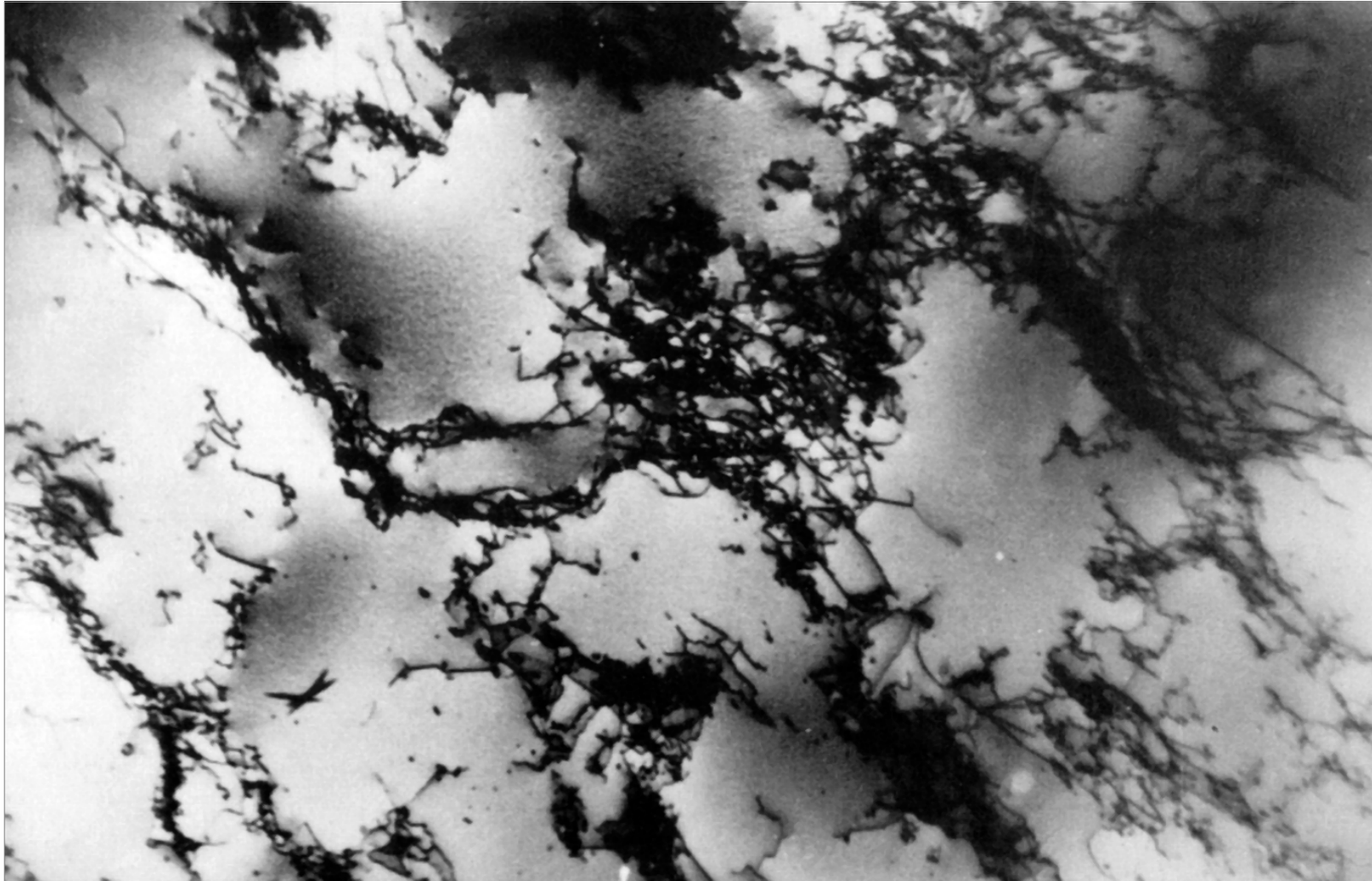
TEM der Versetzungsstruktur in plastisch deformiertem Molybdän, \varepsilon = 12\% . [Luft et al. 1970]
