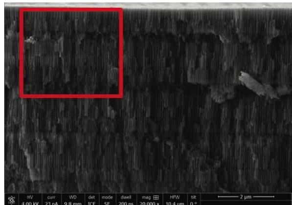
**Abb. 3:** Verzweigte Poren und Markierung des in Abb.4 dargestellten Details.
