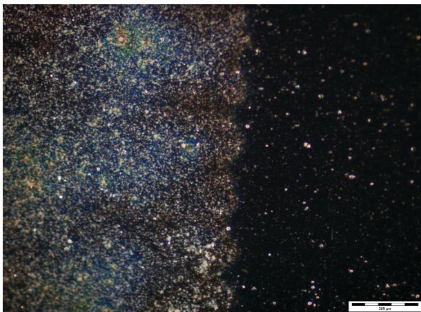
**Abb. 1:** Lichtmikroskopische Dunkelfeldaufnahme (20x) eines gedruckten Kondensatormaterials, am Rand der Beschichtung
