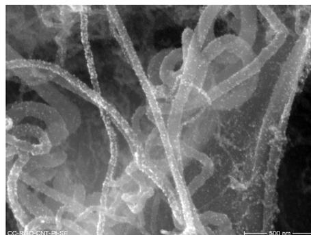
**Abb. 1:** Rasterelektronenmikroskopische Aufnahme von Pt-dekorierten CNTs, die auf Graphen-modifiziertem Kohlenstoffvlies abgeschieden wurden.
