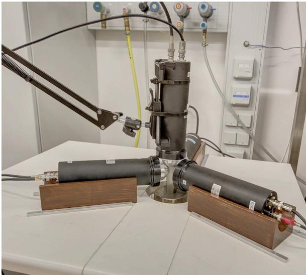
**Abb. 2:** Experimenteller Aufbau der 4 PMT mit Gasadsorptionskammer im Zentrum
