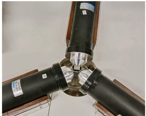
**Abb. 4:** Experimenteller Aufbau von 3 PMT mit Gaskammer im Zentrum und konischen Szintillator-Kappen
