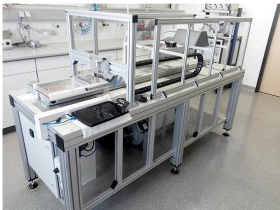
**Abb. 1:** Linearbeschichtungsanlage
