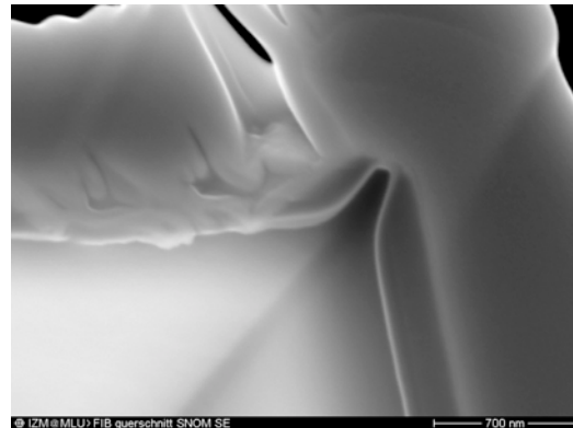
Abb.3: REM-Aufnahme vom per FIB präparierten Querschnitt durch eine der verwendeten SNOM-Spitzen.
