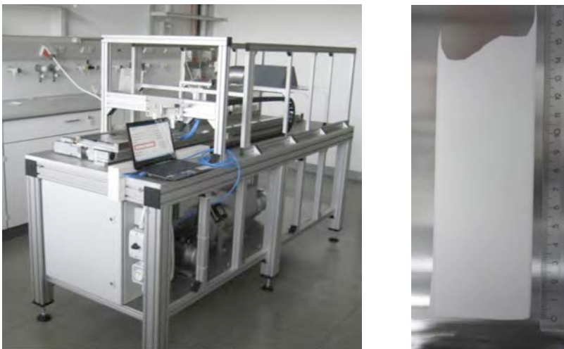
Abb. 5. Linearbeschichtungsmaschine im Technikums des Super-Kon -Projekts ( links ) und mittels Linearbeschichtung hergestellte Kompositschicht ( rechts ).
